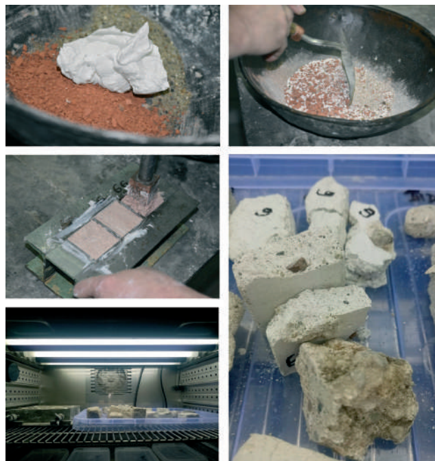
Сл. 8 Припрема лабораторијских модела малтера за конзервацију и процес старења у лабораторијским условима (фото-документација пројекта MoDeCo2000 )
