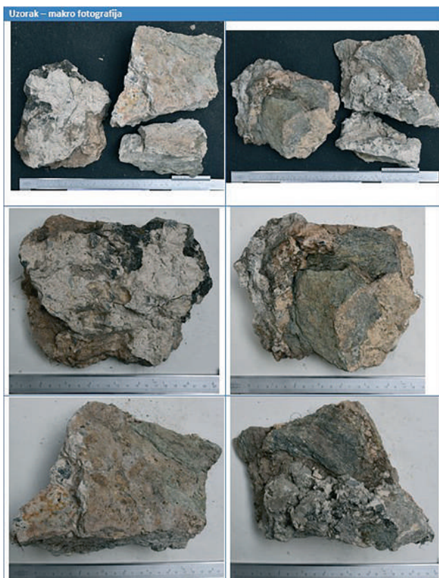
Сл. 5 Извод из фото-документације узорака историјских малтера пре лабораторијских истраживања (фото-документација пројекта MoDeCo2000 )
